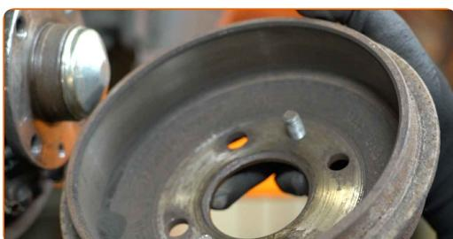
**14** Rengjør festene til bremseskoene. Bruk en stålbørste. Bruk WD-40 spray.
