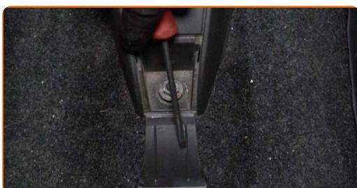
**10** Skru løs de fremste festene til den nedre midtkonsollen. Bruk en pipenøkkelinnsats #10. Bruk en skrallenøkkel.
