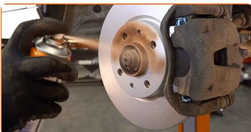
**19** Rengjør overflaten av bremsekiven. Bruk bremserens.
