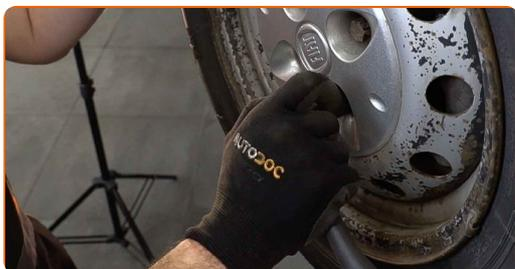
**22** Senk bilen og stram hjulboltene, arbeid på kryss. Bruk en momentnøkkel. Stram den til 98 Nm dreiemoment.
