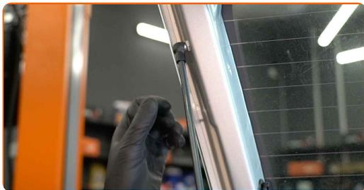
**11** Klem på sikringsringen som kobler gassfjæren til karosseriet.
