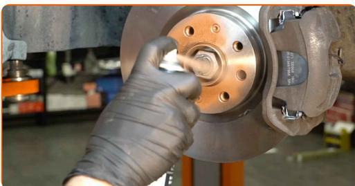
**16** Rengjør overflaten av bremseskiven. Bruk bremsrens.
