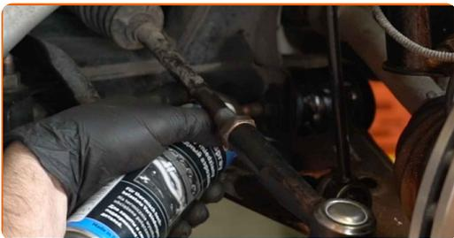
**15** Behandle overflaten hvor bremseskiven kontakter felgen. Bruk kobberfett.
