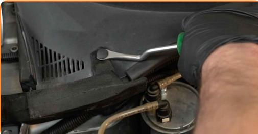
**4** Skru løs festene til torpedoplaten. Bruk en Philips-skrutrekker.
