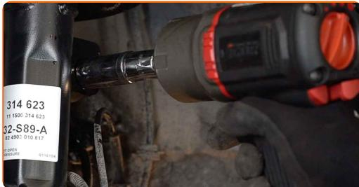
**9** Skru løs og fjern festene på dekselet til hjulbuen. Bruk en pipenøkkelinnsats #10. Bruk en skrallenøkkel. Bruk en Philips-skrutrekker.
