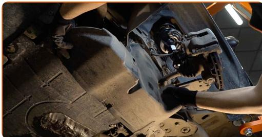
**11** Rengjør festene til stabilisatorleddet. Bruk en stålbørste. Bruk WD-40 spray.
