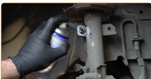
**11** Skru løs festene som kobler stabilisator-ledd til fjærbein. Bruk en pipenøkkelinnsats #15. Bruk en skrallenøkkel.
