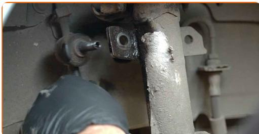
**13** Koble fra ABS-sensorens ledninger. Bruk et demonteringsverktøy for klemmer.
