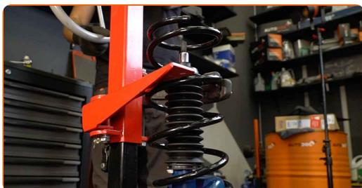
**46** Installer den øvre demperen og monteringslager.
