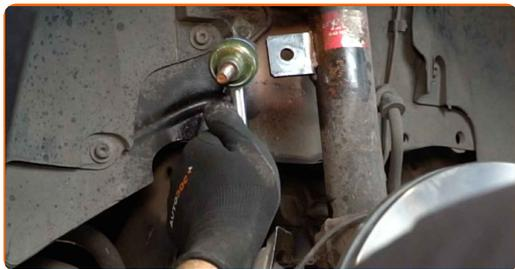
**16** Fjern bremseslangen fra fjærbeinet. Bruk et brekkjern.
