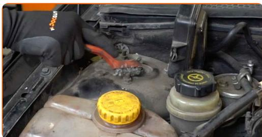
**5** Løsne det øvre festet til fjærbeinet (3 deler). Bruk en pipenøkkelinnsats #13. Bruk en skrallenøkkel.
