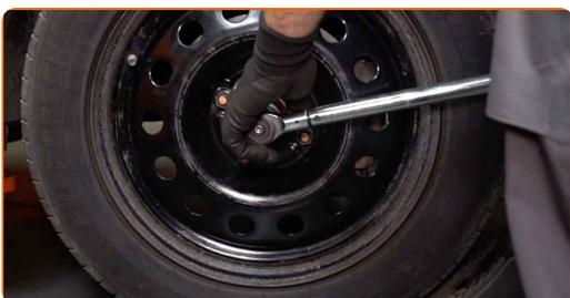
**83** Stram hjulboltene ved å bruke kryss- og tversmønster. Bruk en kraftpipe for hjulmutter #19. Bruk en momentnøkkel. Stram den til 110 Nm dreiemoment.
