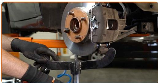
**29** Friggjør nedre feste som kobler fjærbein til styrespindel. Bruk en spesiell pipenøkkel til å fjerne støtdemperen. Bruk en skrallenøkkel.
