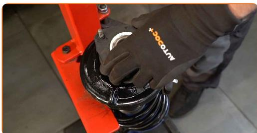
**47** Stram fjærbeinets stempelstangmutter. Bruk en pipenøkkelinnsats #19. Bruk HEX nr. H7. Bruk en momentnøkkel. Stram den til 48 Nm dreiemoment.
