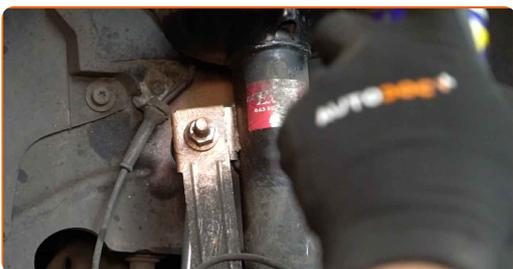
**14** Skru løs festene som kobler stabilisator-ledd til fjærbein. Bruk en kombinasjonsnøkkel #15. Bruk en pipenøkkelinnsats #15. Bruk en skrallenøkkel.
