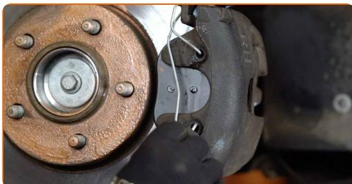
**Utskifting: bremseklosser – FORD C-Max (DM2). Tips fra AUTODOC's eksperter:**
