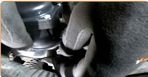
**13** Stram festene til EGR-ventilen. Bruk en pipenøkkelinnsats #8. Bruk en momentnøkkel. Stram den til 9 Nm dreiemoment.
