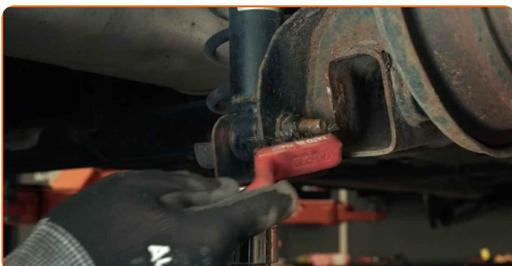
8 Skru fast det nedre festet på støttemperen. Bruk en pipenøkkelinnsats #15. Bruk et svingjern.
