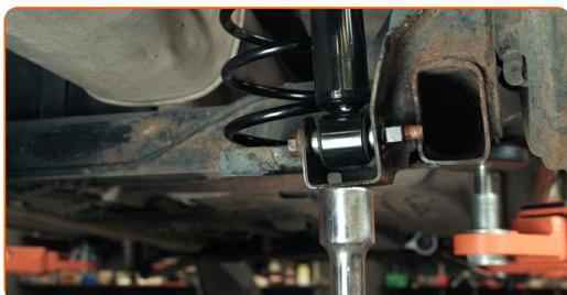
27 Stram det nedre feste på støtdemperen. Bruk en pipenøkkelinnsats #15. Bruk en momentnøkkel. Stram den til 115 Nm dreiemoment.
