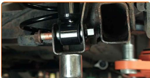
25 Skru inn det nedre festet til støtdemperen. Bruk en pipenøkkelinnsats #15. Bruk en skrallenøkkel.
