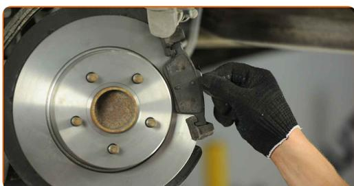
**26** Behandle stempelet til bremsekaliperen. Bruk bremserens.
