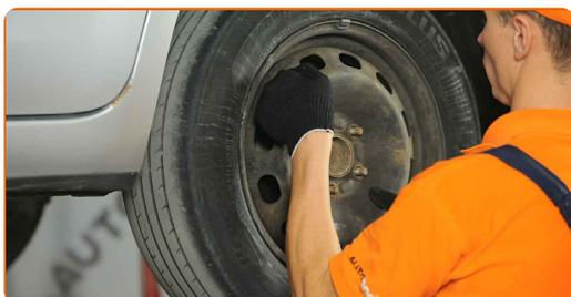
**Utskifting: bremseskiver – FORD Focus II Stasjonsvogn (DA\_, FFS, DS). Tips fra AUTODOCs eksperter:**
