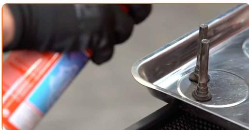
**30** Behandle glidebolter i bremsekaliperen. Bruk fett for glidebolter i bremsekaliperen.
