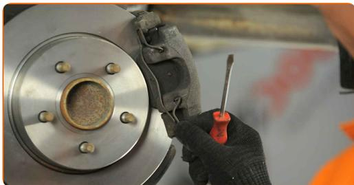
**35** Behandle overflaten hvor bremsekiven kontakter felgen. Bruk kobberfett.
