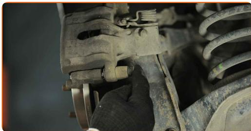
**34** Monter bremsekaliperens holderfjær. Bruk en flat skrutrekker.
