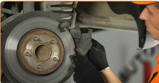
**14** Rengjør festene på braketten til bremsecaliperen. Bruk en stålbørste. Bruk WD-40 spray.
