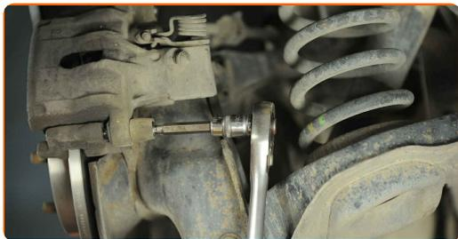
**33** Installer hetten til støvmansjetten på føringsstiftene i bremseklaven.
