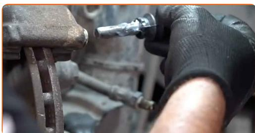
**32** Stram festene til bremsecaliperen. Bruk HEX nr. H7. Bruk en momentnøkkel. Stram den til 35 Nm dreiemoment.
