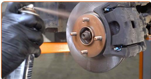
**36** Rengjør overflaten av bremsekiven. Bruk bremserens.
