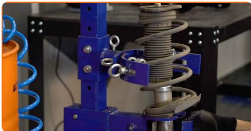
**28** Rengjør støtdemperstangen. Bruk WD-40 spray.
