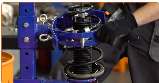
**35** Installer den øvre demperen og monteringslager.
