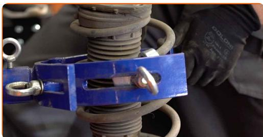
**29** Fjern mutteren på beinets stempelstang. Bruk Torx T40. Bruk en kombinasjonsnøkkel #19. Bruk en skrallenøkkel.
