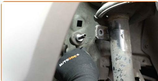
11 Rengjør festet til drivakselen. Bruk en stålbørste. Bruk WD-40 spray.
