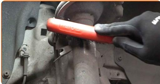
9 Skru løs festene som kobler stabilisator-ledd til fjærbein. Bruk en pipenøkkelinnsats #17. Bruk en skrallenøkkel.
