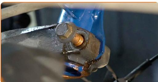
**58** Skru inn festet som forbinder fjærbeinet med styrespindelen. Bruk en pipenøkkelinnsats #15. Bruk en skrallenøkkel.
