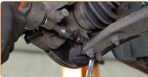
**24** Frigjør festet som kobler kuleledd til styrespindel. Bruk en flat metal meisel. Bruk en hammer.
