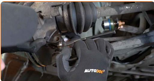
**27** Fjern drivakselen fra styrespindelen. Bruk en spikerdor. Bruk en hammer.
