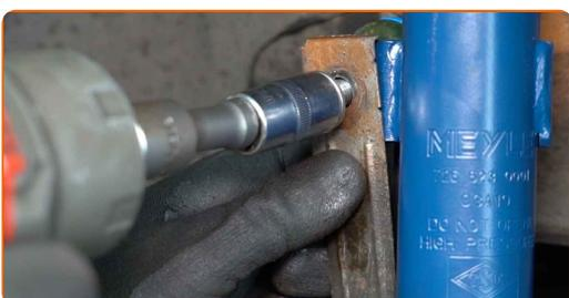
**73** Stram festene som kobler stabilisator-ledd til fjærbein. Bruk en pipenøkkelinnsats #15. Bruk en momentnøkkel. Stram den til 50 Nm dreiemoment.
