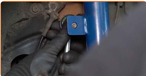
**72** Stram festet for stabilisatorlinken. Bruk en kombinasjonsnøkkel #15. Bruk en pipenøkkelinnsats #15. Bruk en skrallenøkkel.
