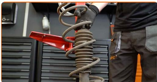
**40** Ta av støtdemper-støvhetten og støtstopperen.
