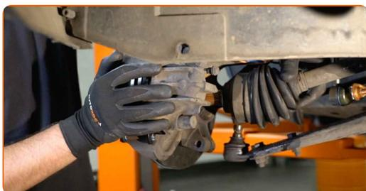
**62** Rengjør kuleleddets monteringsflate. Bruk en stålbørste. Bruk WD-40 spray.
