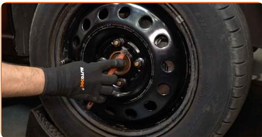
**7** Løsne festet til drivakselen. Bruk en pipenøkkelinnsats #32. Bruk et svingjern.
