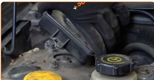
**4** Rengjør festene til støtdempernes øvre montering. Bruk en stålborste. Bruk WD-40 spray.
