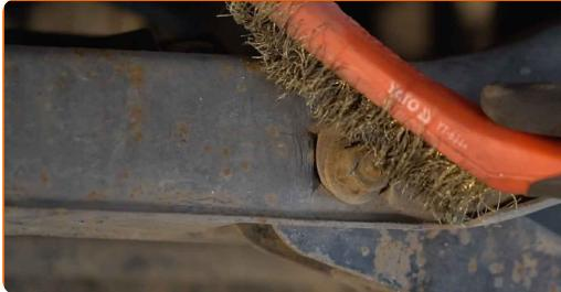
**10** Skru løs stabilisatorstang-festene. Bruk en kombinasjonsnøkkel #15. Bruk en pipenøkkelinnsats #15. Bruk en skrallenøkkel.
