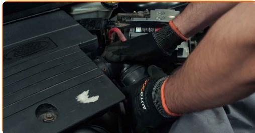
**4** Løsne slangeklemmen på luftinntaket. Bruk en clic-R-slangeklemmetang.
