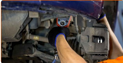
**12** Fjern festebolt. Koble styrespindelen fra fjærbeinet. Bruk en hammer.
