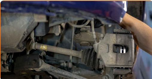
**11** Skru løs nedre feste som kobler fjærbein til styrespindel. Bruk en pipenøkkelinnsats #15. Bruk en skrallenøkkel.
