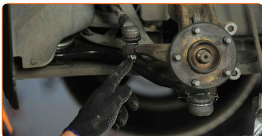
**22** Skru endefestemutteren fast til styrespindelen. Bruk en pipenøkkelinnsats #15. Bruk en skrallenøkkel.
