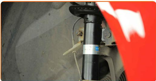
**70** Stram festene som kobler stabilisator-ledd til fjærbein. Bruk en kombinasjonsnøkkel #17. Bruk HEX nr. H5. Bruk en momentnøkkel. Stram den til 48 Nm dreiemoment.
