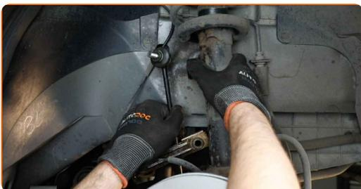
**12** Rengjør festet til drivakselen. Bruk en stålbørste. Bruk WD-40 spray.
