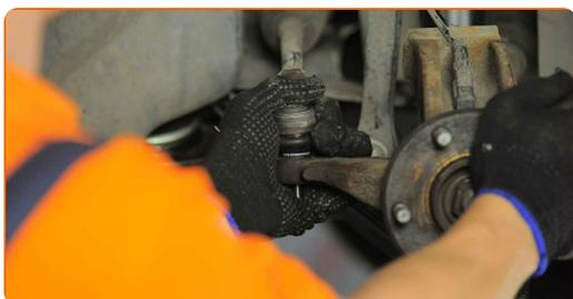
**66** Stram festemutteren som kobler endeledet til rattspindelen. Bruk en pipenøkkelinnsats #15. Bruk en momentnøkkel. Stram den til 40 Nm dreiemoment.
