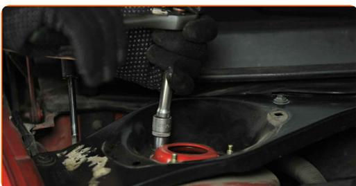
**49** Installer beskyttelseshetten på støtdempermonteringen.
