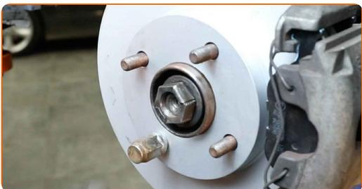
**73** Stram mutteren til drivakselen. Bruk en pipenøkkelinnsats #32. Bruk en momentnøkkel. Stram den til 290 Nm dreiemoment.
