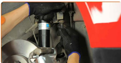
**65** Koble strekkstangenden til styrespindelen.
