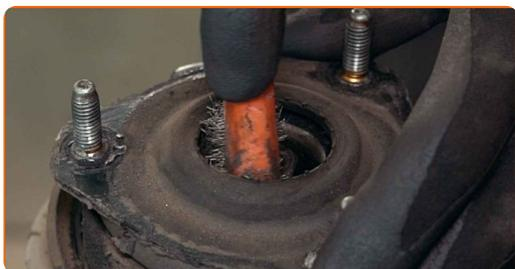
**36** Skru løs mutteren fra fjærbeinets stempelstang. Bruk en pipenøkkelinnsats #19. Bruk HEX nr. H6. Bruk en skrallenøkkel.
