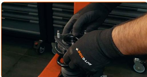
45 Stram fjærbeinets stempelstangmutter. Bruk en pipenøkkelinnsats #19. Bruk HEX nr. H6. Bruk en momentnøkkel. Stram den til 55 Nm dreiemoment.
