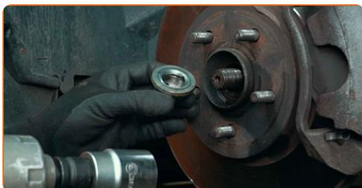
**23** Rengjør festene som kobler kuleleddet til styrearmen i hjulopphenget. Bruk en stålbørste. Bruk WD-40 spray.
