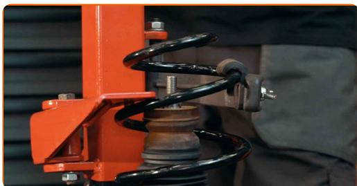
44 Installer den øvre demperen og monteringslager.
