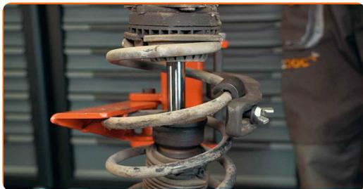
**35** Behandle stangen til fjærbeinet. Bruk en stålbørste. Bruk WD-40 spray.
