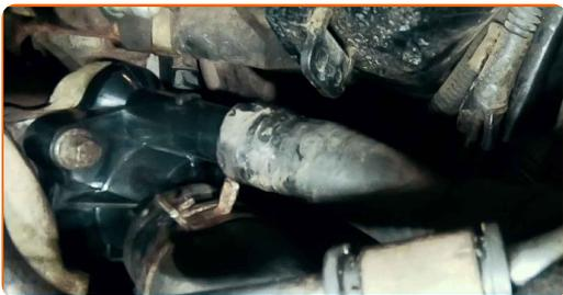
**29** Løsne klemmene til kjølevæskeslangene. Bruk en clic-R-slangeklemmetang.
