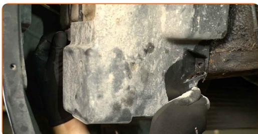
**12** Rengjør spylervæskesumpen. Bruk en nylonbørste. Bruk en universal rengjørings-spray.
