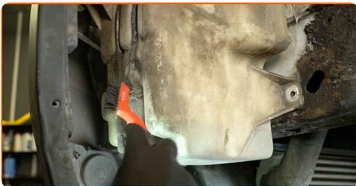
**13** Løsne kontakten fra spylervæskesumpen. Bruk en dekkspak.
