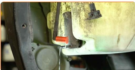
**16** Fjern spylervæskesumpen. Bruk en slangeklemmetang.
