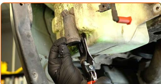
**17** Fjern pakningen til spylervæskepumpen. Bruk en dekkspak.
