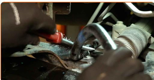
**18** Monter en ny stabilisatorforing på den ene siden av akselen.
