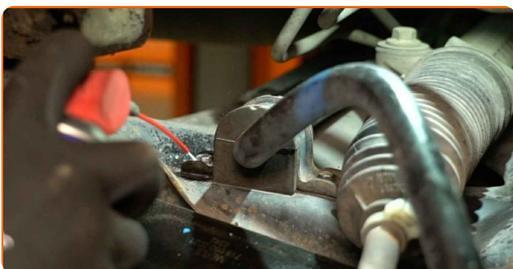
**17** Rengjør festepunktene til stabilisatorforingen. Bruk en stålbørste. Bruk en universal rengjøringspray.
