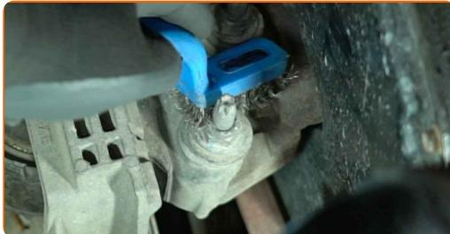
**4** Skru løs de nedre festene på motorfestet. Bruk en pipenøkkelinnsats #13. Bruk en skrallenøkkel.
