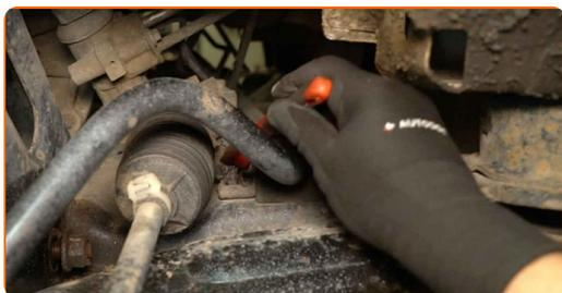
**12** Skru ut festene til braketten til stabilisatorforingen. Bruk en pipenøkkelinnsats #10. Bruk en skrallenøkkel.
