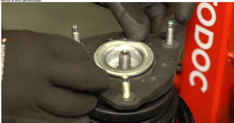
64 Monter og stram til mutteren til fjærbeinets stempelstang. Bruk en 18 mm pipe til fjærbeinsmutter. Bruk en 6 mm sekskantet forlenger. Bruk en momentnøkkel. Dreiemoment: 70 Nm.
