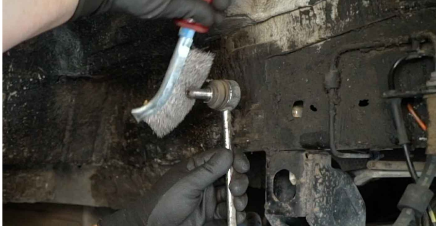
47 Rengjør rillene på drivaksleddet. Bruk en stålbørste. Bruk en universal rengjøringspray.
