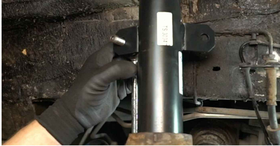
77 Monter kabelbraketten til ABS-sensoren og skru på festemutteren.
