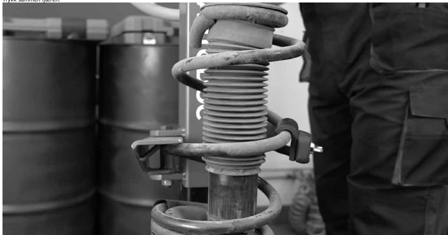
51 Rengjør den øverste delen av stempelstangen til fjærbeinet. Bruk en stålbørste. Bruk WD-40 spray.
