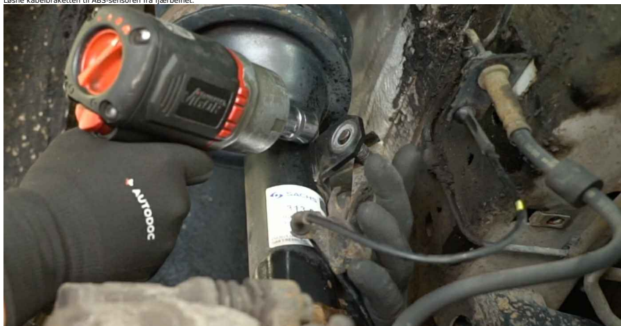
23 Skru ut festet som forbinder stabilisatorstaget med fjærbeinet. Bruk en kombinasjonsnøkkel #19. Bruk en sekskant bits på 5 mm. Bruk en skrallenøkkel.
