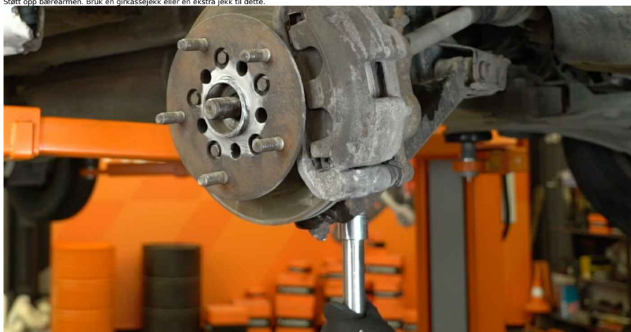
28 Løsne drivakselen fra styrespindelen. Bruk en dor. Bruk en hammer.
