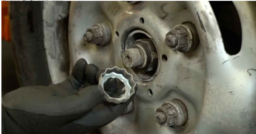
13 Rengjør akselmutteren. Bruk en stålbørste. Bruk WD-40 spray.
