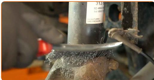
**21** Skru løs festet på kabelbraketten til ABS-sensoren. Bruk en pipenøkkelinnsett #18. Bruk en skrallenøkkel.
