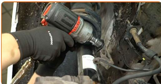
**22** Løsne kabelbraketten til ABS-sensoren fra fjærbeinet.
