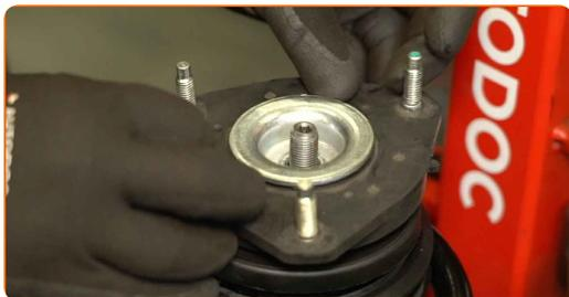
**62** Monter og stram til mutteren til fjærbeinets stempelstang. Bruk en 18 mm pipe til fjærbeinmutter. Bruk en 6 mm sekskantet forlenger. Bruk en momentnøkkel. Dreiemoment: 70 Nm.
