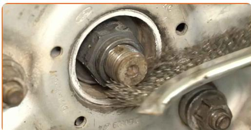
**14** Løsne akselmutteren. Bruk en pipenøkkelinnsats #36. Bruk en hjulmutternøkkel.
