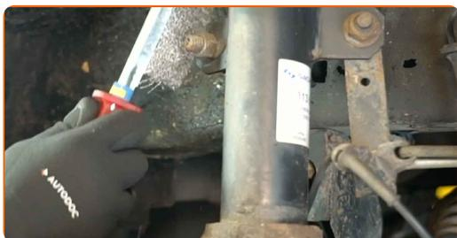
**19** Rengjør festet på kabelbraketten til ABS-sensoren. Bruk en stålbørste. Bruk WD-40 spray.
