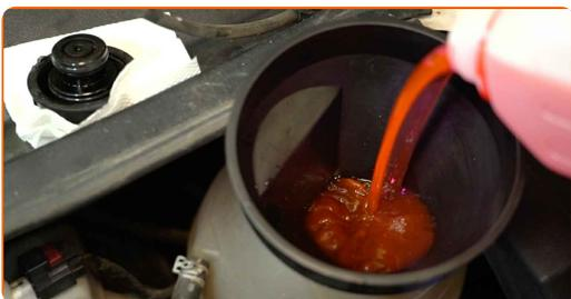
Utskifting: radiator – FORD Transit Mk6 Minibuss (V347, V348). Tips fra AUTODOCs eksperter:
