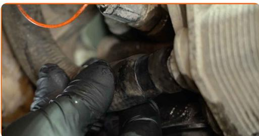
**11** Stram til klemmen på kjølevæskeslangen til oljekjøleren. Bruk en pipenøkkelinnsats #7. Bruk en skrallenøkkel.
