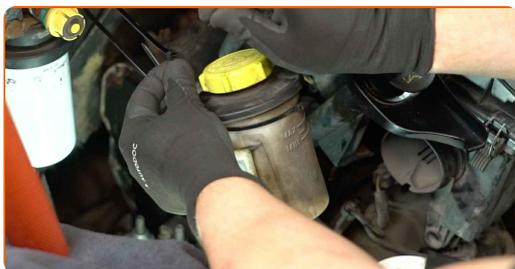
**20** Løsne klemmen på den nedre kjølevæskeslangen. Bruk en slangeklemmetang.
