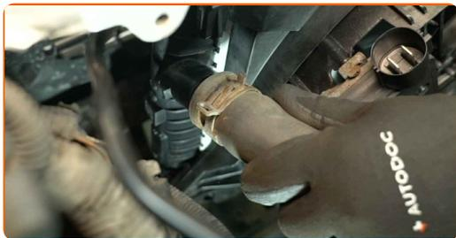
**49** Klargjør kontakten til motorens kjølevifte. Bruk en kontaktspray til dette.
