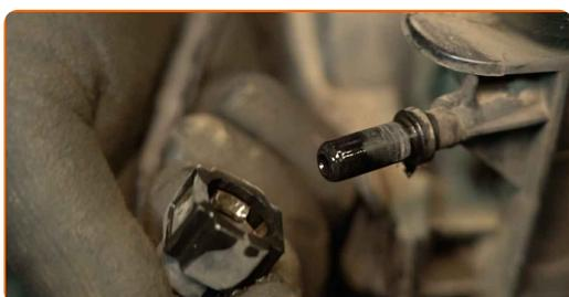
**28** Løsne overløpsslangen fra festene på radiatoren.
