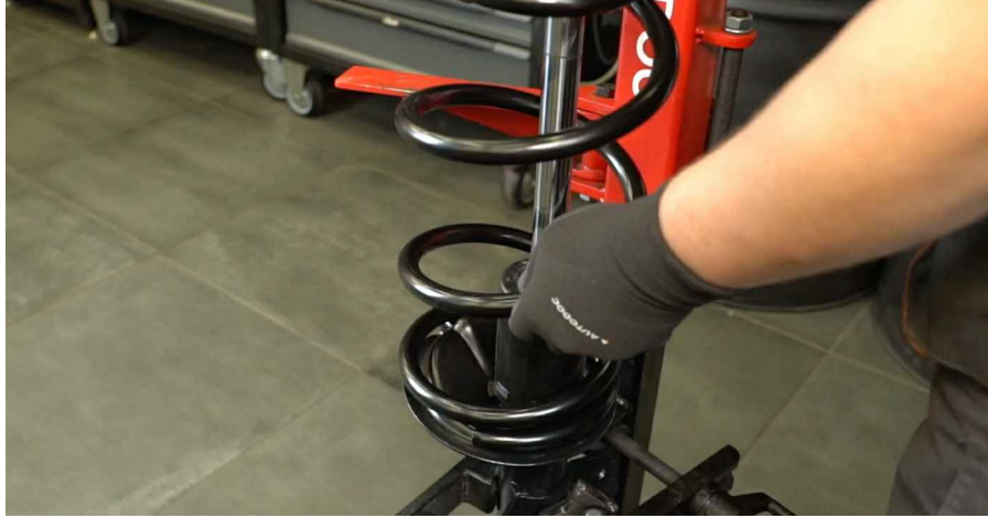
61 Monter en mansjett, anslagsbuffer samt et nytt støttelager.
