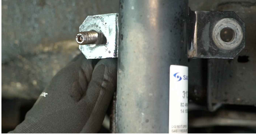
25 Skru av akselmutteren. Bruk en pipenøkkelinnsats #36. Bruk en skrallekkel.
