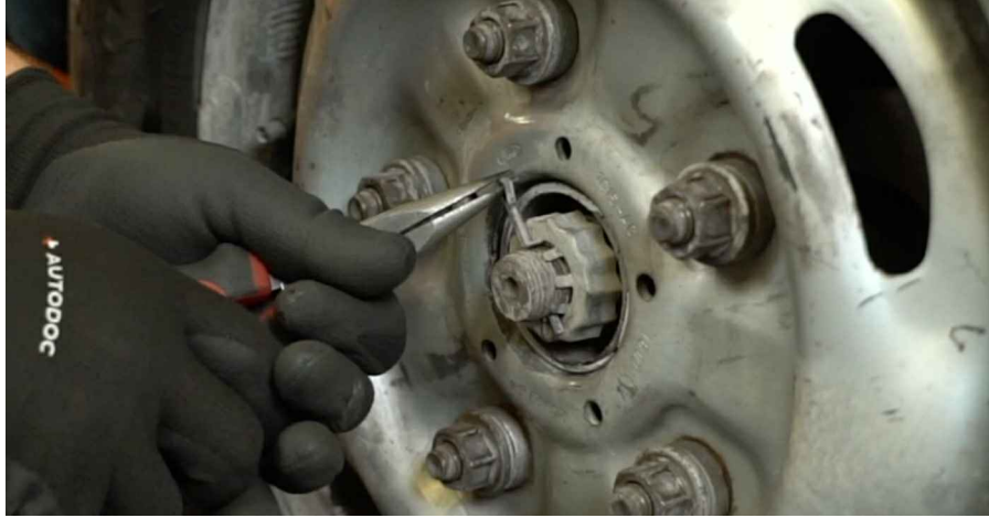
12 Fjern sentreringsringen fra akselmutteren.
