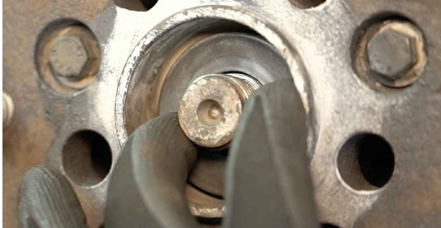
73 Skru på akselmutteren. Bruk en pipenøkkelinsats #36. Bruk en skrallekkjel.
