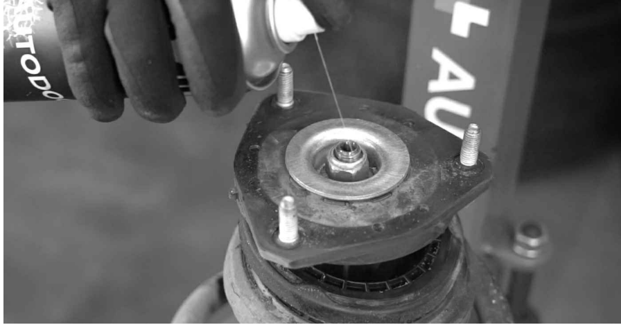
52 Skruløst mutteren på stempelstangen til fjærbeinet. Bruk en 18 mm pipe til fjærbeinsmutter. Bruk en 6 mm sekskantet forlenger. Bruk en skrallekkjel.
