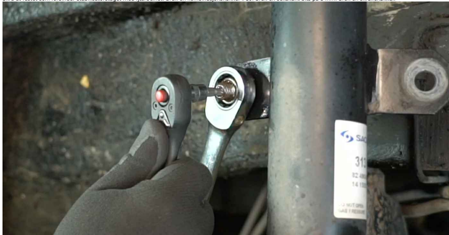
24 Koble stabilisatorstaget fra fjærbeinet.
