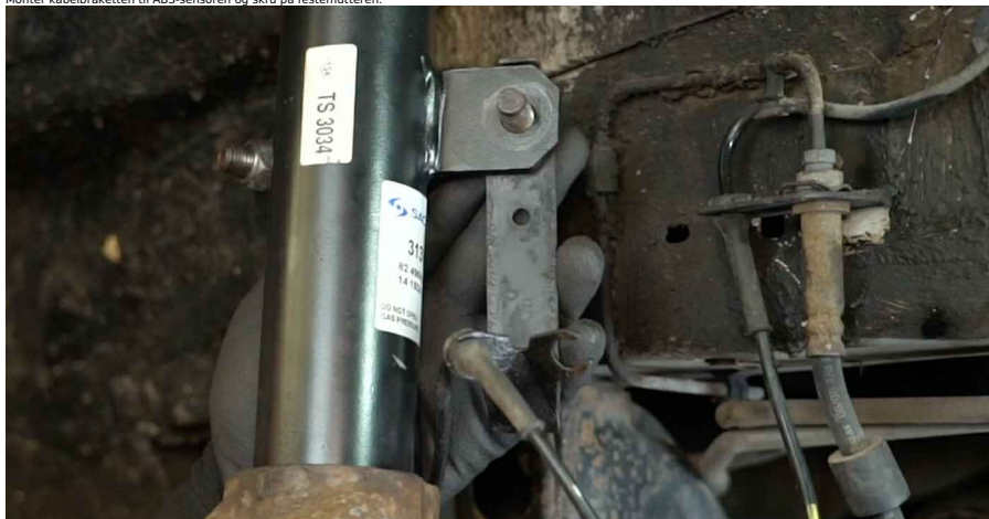
78 Stram til festet som forbinder stabilisatorstaget med fjærbeinet. Bruk en pipenøkkelnsats #19. Bruk en momentnøkkel. Dreiemoment: 55 Nm.
