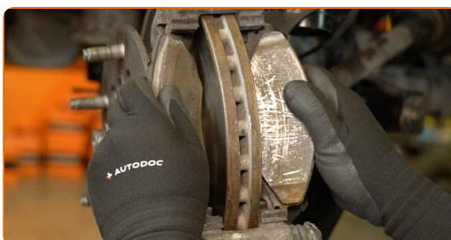
**26** Rengjør festene til braketten til bremsekaliperen. Bruk en stålbørste. Bruk WD-40 spray.
