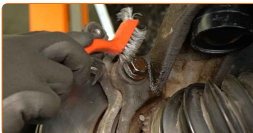
**27** Skru løs festene til braketten til bremsekaliperen. Bruk en pipenøkkelinnsats #18. Bruk en hjulmutternøkkel.
