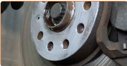
**64** Rengjør overflaten av bremseskiven. Bruk bremsereens.
