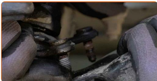
**23** Løft opp styrespindelen. Bruk en hydraulisk jekk.
