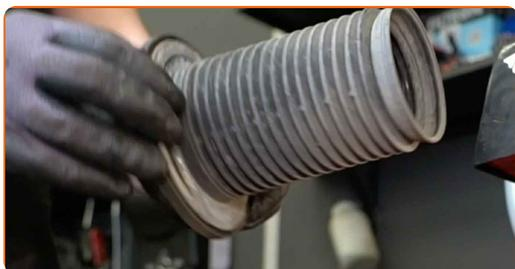
**36** Monter den øvre holderen til fjærbeinet sammen med støtstopperen.
