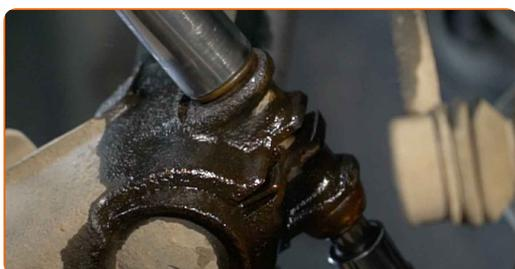
**18** Skru løs festene som binder drivaksel til hjulnavet. Bruk 12-kant-pipe nummer 24. Bruk et svingjern.
