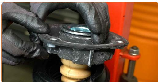
**37** Stram fjærbeinets stempelstangmutter. Bruk en 21 mm pipe for fjærbeinmutter. Bruk HEX nr. H7. Bruk en momentnøkkel. Stram den til 60 Nm dreiemoment.
