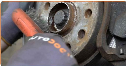
**63** Behandle overflaten hvor bremseskiven kontakter felgen. Bruk keramisk pasta.
