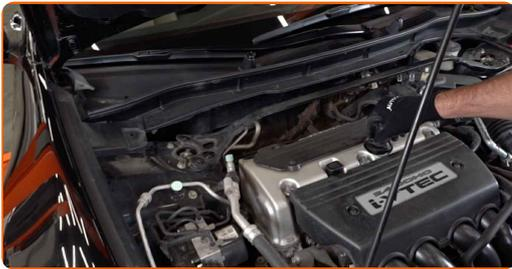
25 Kjør motoren i noen minutter. Etter at varselampen for oljetrykk slukkes, stopp motoren.
