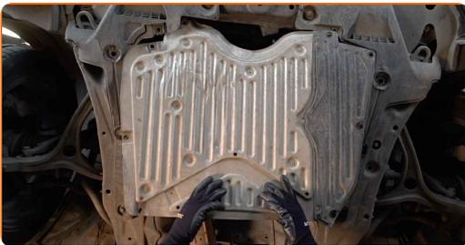
19 Skru fast festene på nedre lydisolasjon. Bruk en pipenøkkelinnsats #10. Bruk en skrallenøkkel.
