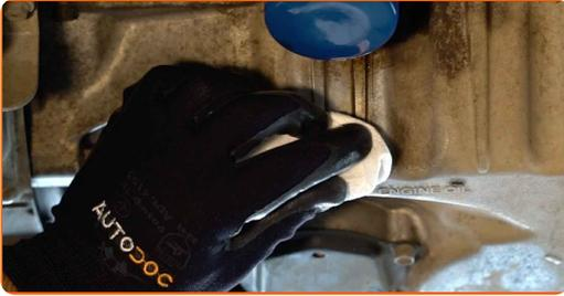
17 Skru inn den nye dreneringspluggen og stram den. Bruk en pipenøkkelinnsats #17. Bruk en momentnøkkel. Stram den til 38 Nm dreiemoment.
