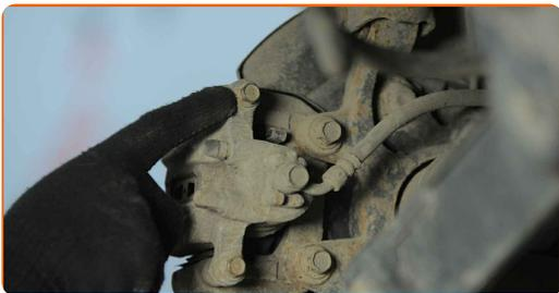
**8** Skru løs bremsecalippernes feste. Bruk en kombinasjonsnøkkel #17. Bruk en pipenøkkelinnsats #12. Bruk en skrallenøkkel.
