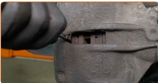
**10** Fjern bremsecaliperen. Bruk et brekkjern.
