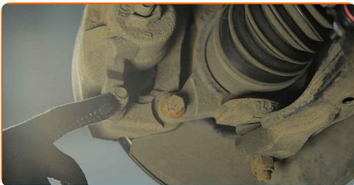
**8** Skru løs bremsecalippernes feste. Bruk en pipenøkkelinnsats #12. Bruk en skrallenøkkel.
