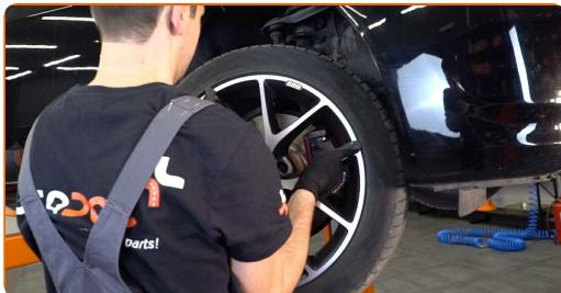
Utskifting: bremseklosser – HONDA ACCORD VIII Stasjonsvogn. Tips fra AUTODOCs eksperter:
