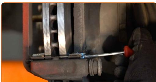
Utskifting: bremseklosser – HONDA ACCORD VIII Stasjonsvogn. Tips fra
