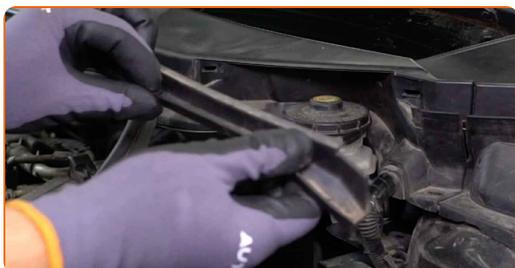
4 Skru løs tanklokket for bremsevæsken.
