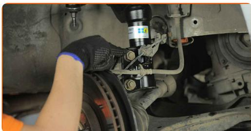
**15** Skru løs nedre feste som kobler fjærbein til styrespindel. Bruk en kombinasjonsnøkkel #19. Bruk en pipenøkkelinnsats #22. Bruk en skrallenøkkel.
