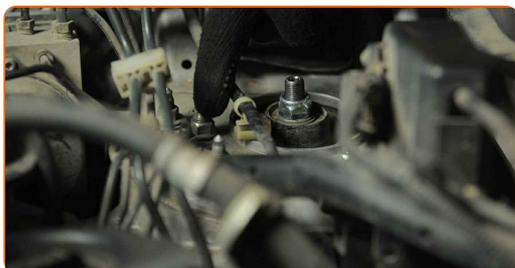
22 Skru løs toppfestet på fjærbeinmonteringen. Bruk en pipenøkkelinnsats #14. Bruk en skrallenøkkel.
