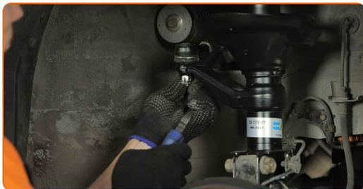
**53** Behandle festene til fjærbeinet. Behandle festet som kobler endeledet til rattspindelen. Bruk kobberfett.
