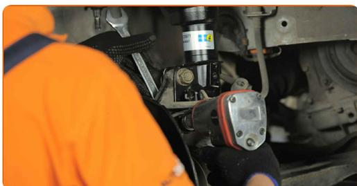
**46** Monter braketten på støtdemperens fjærbein.
