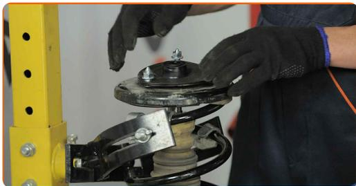
**32** Stram fjærbeinets stempelstangmutter. Bruk en kombinasjonsnøkkel #19. Bruk HEX nr. H7. Bruk en momentnøkkel. Stram den til 44 Nm dreiemoment.
