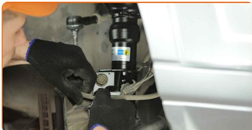
**14** Rengjør festene som kobler fjærbein til styrespindel. Bruk en stålbørste. Bruk WD-40 spray.
