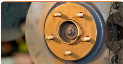
**55** Rengjør overflaten av bremseskiven. Bruk bremsrens.
