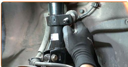
**48** Stram festene som kobler stabilisator-ledd til fjærbein. Bruk en pipenøkkelinnsats #16. Bruk en momentnøkkel. Stram den til 23 Nm dreiemoment.
