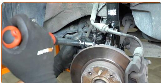
**46** Koble til ABS-sensorledningene. Fest bremseslangen. Bruk et brekkjern.
