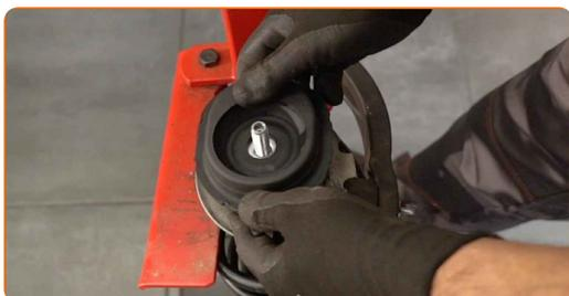
**34** Stram fjærbeinets stempelstangmutter. Bruk en kombinasjonsnøkkel #27. Bruk HEX nr. H6. Bruk en momentnøkkel. Stram den til 45 Nm dreiemoment.
