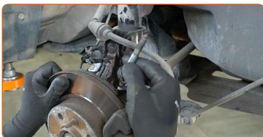
**19** Koble styrespindelen fra fjærbeinet. Bruk et brekkjern.
