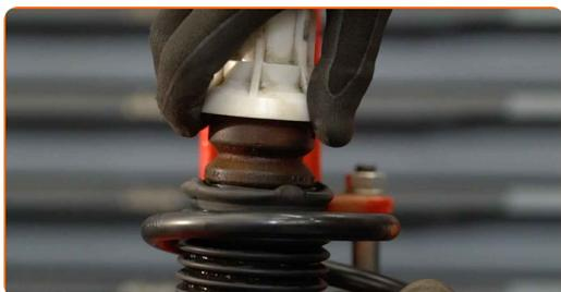
**33** Installer den øvre demperen og monteringslager.
