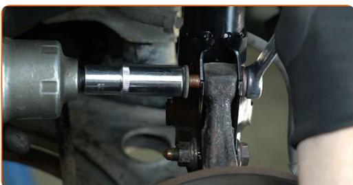
**37** Stram nedre fester som kobler fjærbein til styrespindel. Bruk en kombinasjonsnøkkel #18. Bruk en pipenøkkelinnsats #18. Bruk en momentnøkkel. Stram den til 95 Nm dreiemoment.
