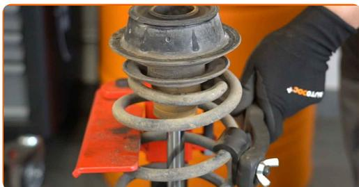
23 Fjern mutteren på beinets stempelstang. Bruk en kombinasjonsnøkkel #21. Bruk en 14,5 mm pipe for fjærbeinmutter. Bruk en skrallenøkkel.
