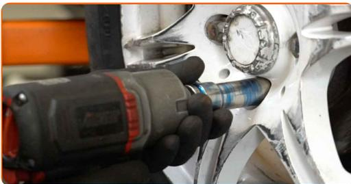
48 Senk bilen og stram hjulboltene, arbeid på kryss. Bruk en kraftpipe for hjulmutter #17. Bruk en momentnøkkel. Stram den til 110 Nm dreiemoment.
