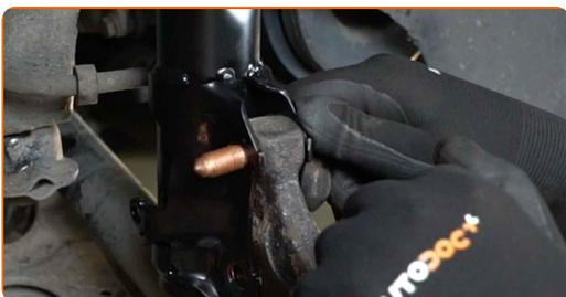
**36** Skru inn festene som kobler fjærbeinet til styrespindelen. Bruk en kombinasjonsnøkkel #18. Bruk en pipenøkkelinnsats #18. Bruk et svingjern.
