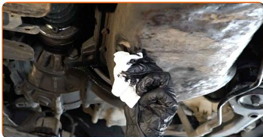
**17** Skru inn den nye dreneringspluggen og stram den. Bruk en pipenøkkelinnsats #19. Bruk en momentnøkkel. Stram den til 28 Nm dreiemoment.
