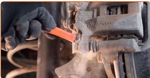
**8** Spre bremseklossene. Bruk et brekkjern.
