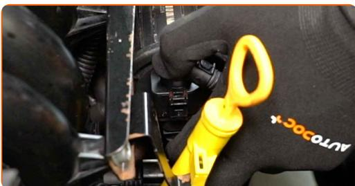
**46** Fjern mikrofiberkluten fra de sekundære luftpumpekanalene.
