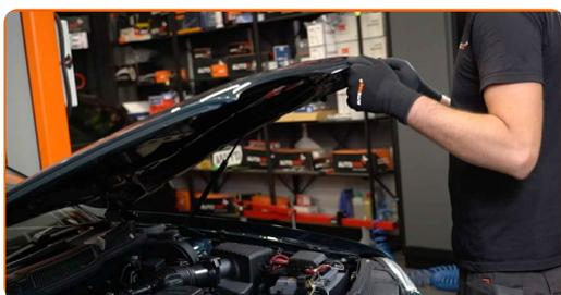
**2** Bruk et deksel for å beskytte skjermen for å unngå skader på lakken og plastdelene på bilen.
