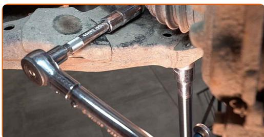
**51** Stram det nedre festet på støtdemperen. Bruk en kombinasjonsnøkkel #19. Bruk en pipenøkkelinnsats #19. Bruk en momentnøkkel. Stram den til 135 Nm dreiemoment.
