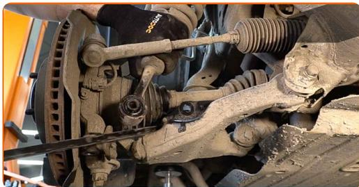
**21** Løft opp styrespindelen. Bruk en hydraulisk jekk.
