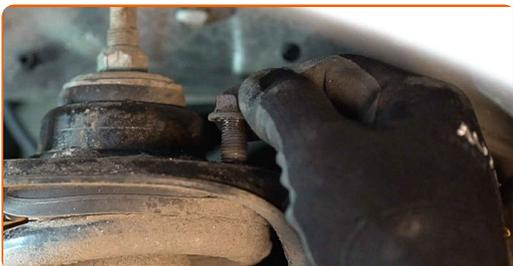
**20** Koble fra nedre del av fjærbeinet. Bruk et brekkjern.
