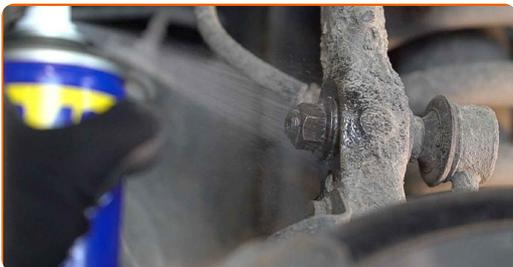
**9** Skru løs festelementene som fester stabilisatorleddet til styrespindelen. Bruk en pipenøkkelinnsats #17. Bruk HEX nr. H6. Bruk en kombinasjonsnøkkel #17.
