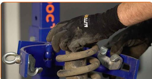
**30** Ta vekk den gamle støtdemperen fra den hydrauliske kompressoren.
