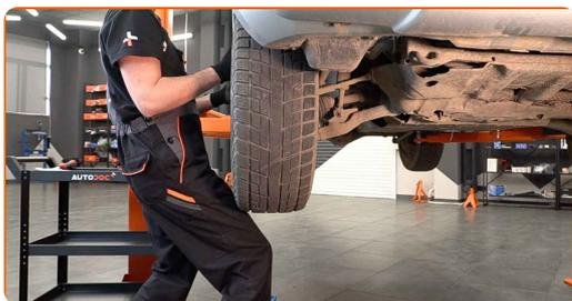
**6** Løsne festene på det nedre dekselet til oljepannen. Bruk en pipenøkkelinnsats #12.
