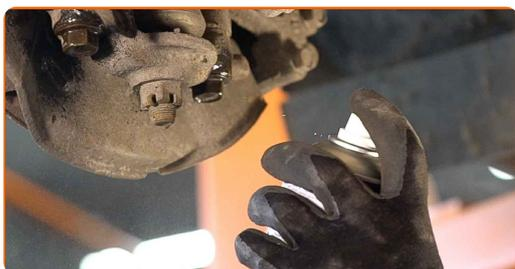
**13** Skru løs det nedre festet på fjærbeinet. Bruk en pipenøkkelinnsats #19.
