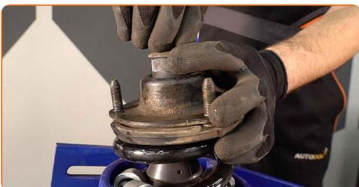
**31** Stram fjærbeinets stempelstangmutter. Bruk en kombinasjonsnøkkel #17. Bruke en justerbar skiftenøkkel. Bruk en momentnøkkel. Stram den til 25 Nm dreiemoment.
