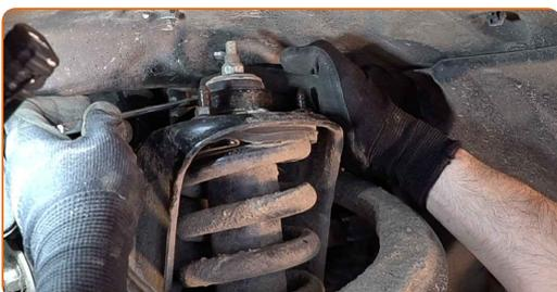
**19** Koble fra nedre del av fjærbeinet. Bruk et brekkjern.
