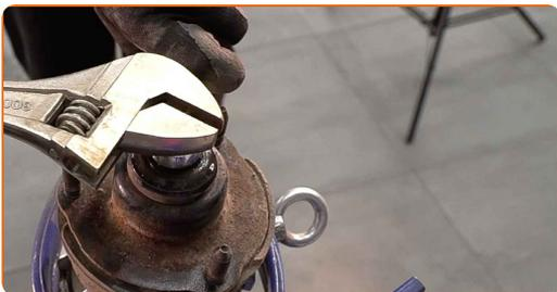
**26** Fjern det øvre beinfestet. Bruk et brekkjern. Slipp spiralfjæren.
