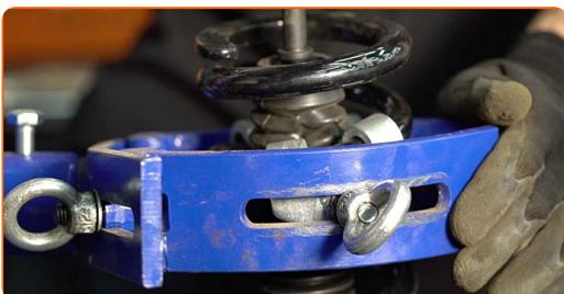
**30** Installer den øvre demperen og monteringslager.
