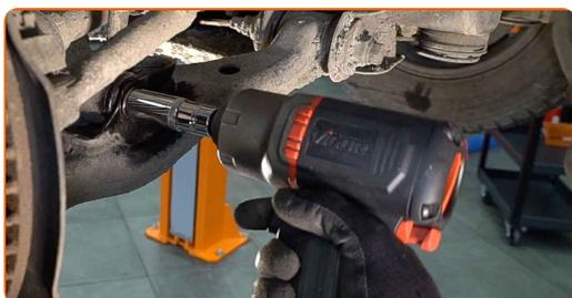
**14** Skru kuleleddfestet til styrespindelen. Bruk en pipenøkkelinnsats #19. Bruk et svingjern.
