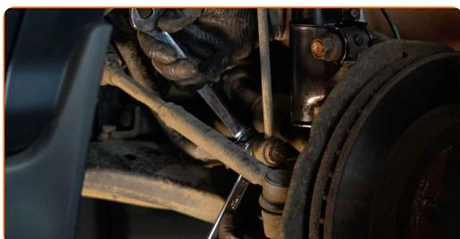
**8** Skru løs festene som kobler stabilisator-ledd til fjærbein. Bruk en pipenøkkelinnsats #17. Bruk en skrallenøkkel.
