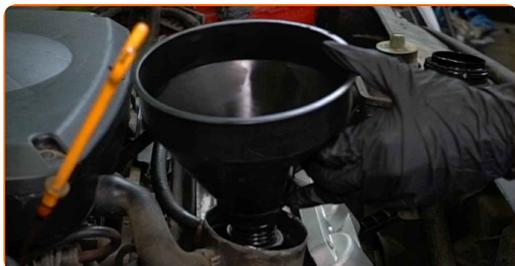
21 Tøm oljen inn i motoren gjennom påfyllingshullet. Nødvendig mengde olje: 4.4.
