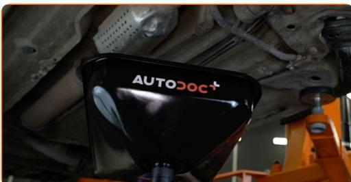
7 Rengjør området rundt dreneringshullet til oljepannen. Bruk en stålbørste. Bruk universal rengjørings-spray.
