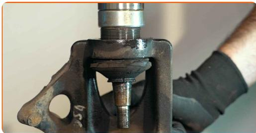
**44** Rengjør kulleleddets monteringsflate. Bruk en stålbørste. Bruk WD-40 spray.
