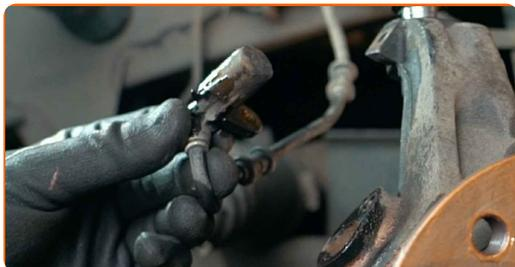
**35** Rengjør festet som kobler kuleledd til styrespindel. Bruk en stålbørste. Bruk WD-40 spray.
