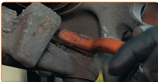
**36** Skru løs festet som forbinder bærekulen til den nedre bæreammen med styrespindelen. Bruk en kombinasjonsnøkkel #22.
