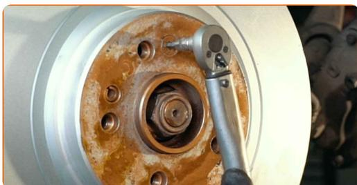
**77** Installer bremsecaliperen sammen med braketten.
