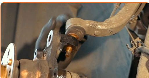
**56** Koble strekkstangenden til styrespindelen.
