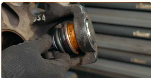
**46** Skru fast festet som kobler kulleleddet til styrespindelen. Bruk en spesialpipe for låsemuttere. Bruk et svingjern.
