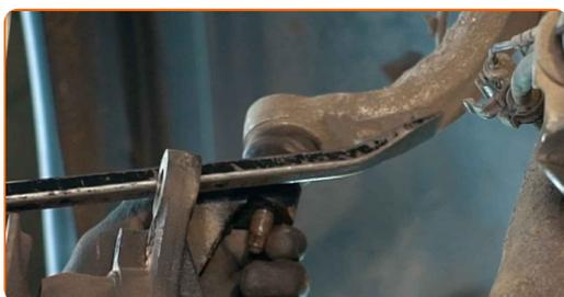
**40** Fjern bærekulen til den nedre bæreamen fra styrespindelen. Bruk en avtrekker for kuleledd.
