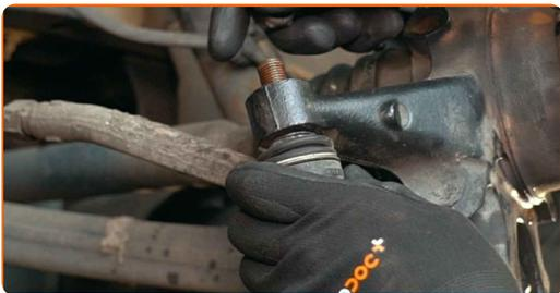
**57** Skru på festemutteren som kobler endeledet til rattspindelen. Bruk en pipenøkkelinnsats #22. Bruk en skrallenøkkel.
