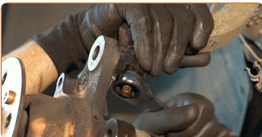
**60** Koble bærekulen til den nedre bæreamen til styrespindelen.
