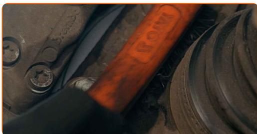
**14** Skru løs kalipperbrakettfestet. Bruk en pipenøkkelinnsats #22. Bruk en skrallenøkkel. Bruk et svingjern.
