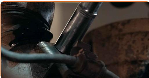
**12** Spre bremseklossene. Bruk et brekkjern.
