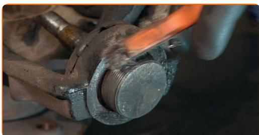
**43** Fjern bærekulen fra styrespindelen. Bruk et avtrekkersett for hylser og lager.
