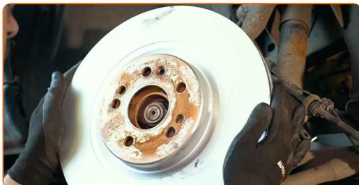
**76** Stram bremseskivefestet. Bruk HEX nr. H5. Bruk en momentnøkkel. Stram den til 8 Nm dreiemoment.
