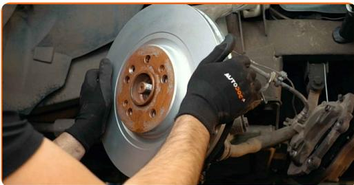
**23** Rengjør festene til dekselet til bremseskiven. Bruk en stålbørste. Bruk WD-40 spray.
