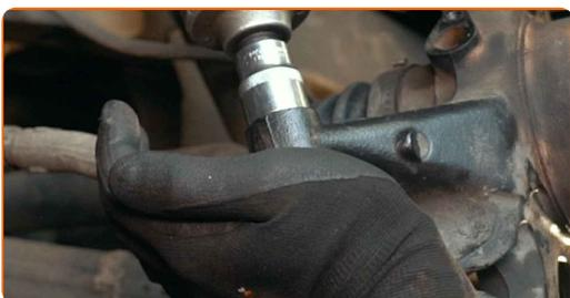
**58** Koble bærekulen til den øvre bæreamen til styrespindelen.
