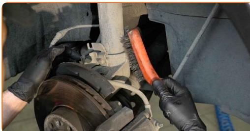
**13** Skru løs nedre feste som kobler fjærbein til styrespindel. Bruk en pipenøkkelinnsats #17. Bruk en skrallenøkkel.
