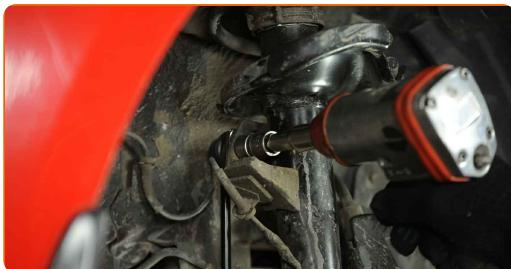
**8** Fjern braketten til ABS-ledningsnettet.
