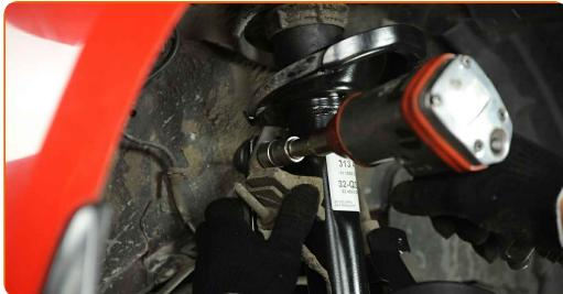
**55** Behandle festene til fjærbeinet. Behandle alle leddene på stabilisatorleddet. Bruk kobberfett.
