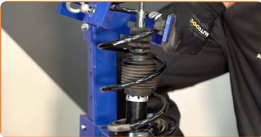
30 Installer den øvre demperen og monteringslager.
