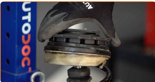
31 Stram fjærbeinets stempelstangmutter. Bruk HEX nr. H6. Bruk en kombinasjonsnøkkel #18. Bruk en momentnøkkel. Stram den til 62 Nm dreiemoment.
