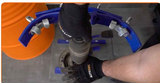
27 Installer støvbeskytteren og støtstopperen på støtdemperen.
