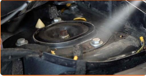
5 Løsne det øverste festet på fjærbeinets montering. Bruk en pipenøkkelinnsats #13. Bruk en skrallenøkkel.
