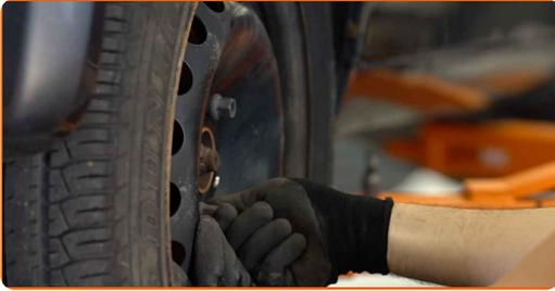
46 Senk bilen og stram hjulboltene, arbeid på kryss. Bruk en kraftpipe for hjulmutter #19. Bruk en momentnøkkel. Stram den til 110 Nm dreiemoment.
